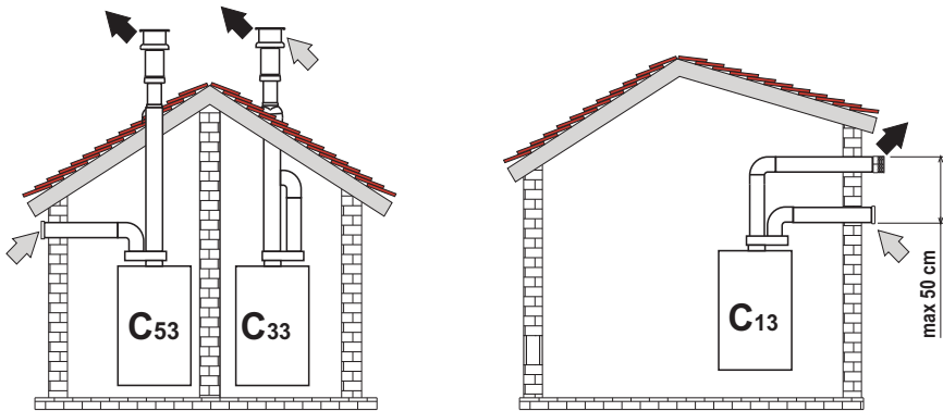
fig. 25 - Esempi di collegamento con tubi separati
