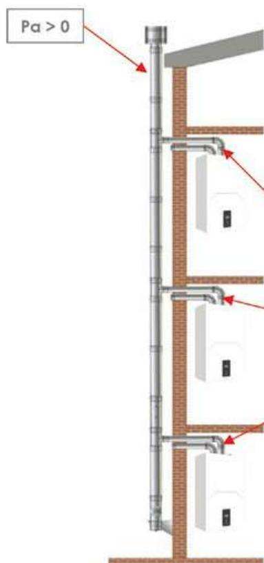
**F.P.S.:** Sistema di Protezione Fumi. L'installazione esterna del kit specifico anti ritorno fumi (optional) permette una **facile connessione a sistemi collettivi fumari in pressione** (es. nei risanamenti), in accordo alla normativa UNI 7129. **Per gli installatori** la soluzione della canna collettiva in pressione è **più economica** (riduzione dei diametri dei camini).
