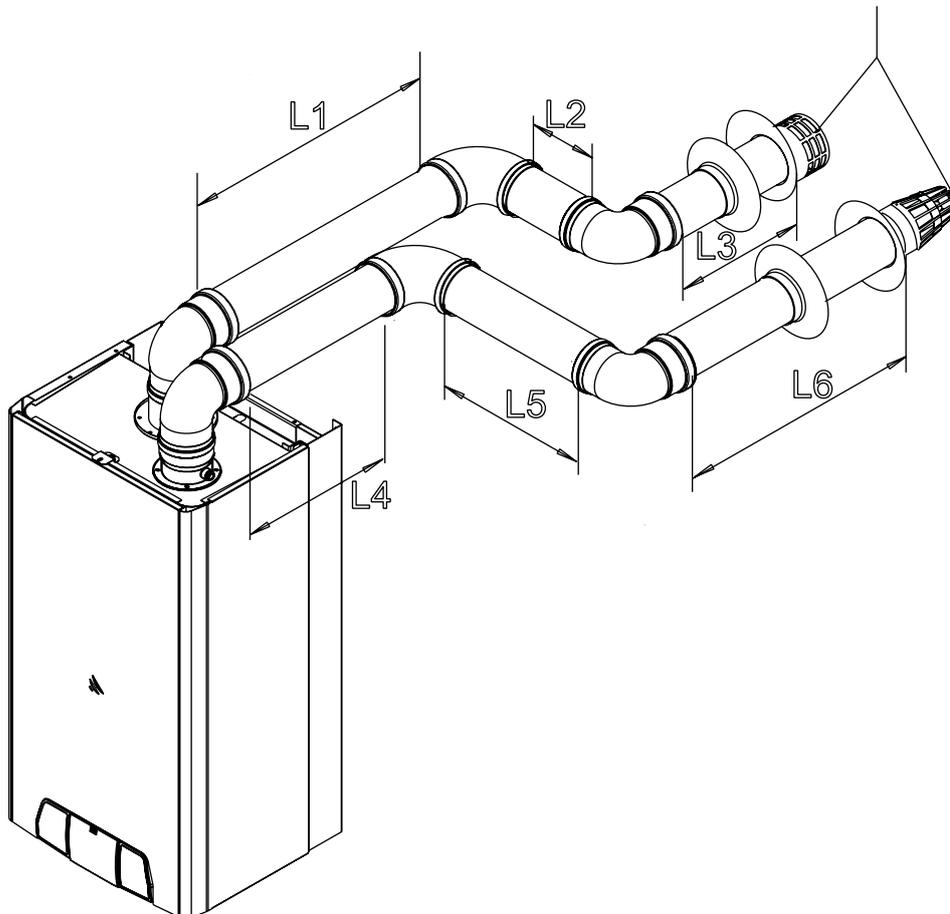
**Nota:** Obsérvese que en los ejemplos dados se determinan distancias mínimas que deben respetarse en cualquier otro tipo de configuración para asegurar la buena evacuación de los productos de combustión.
