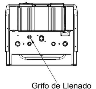
NOTA: El circuito de calefacción debe funcionar presurizado (Válvula de llenado cerrada) y sin reposición de agua permanente (Válvula de llenado abierta).
