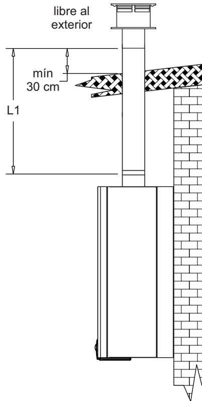
**Nota:** Obsérvese que en los ejemplos dados se determinan distancias mínimas que deben respetarse en cualquier otro tipo de configuración para asegurar la buena evacuación de los productos de combustión.
