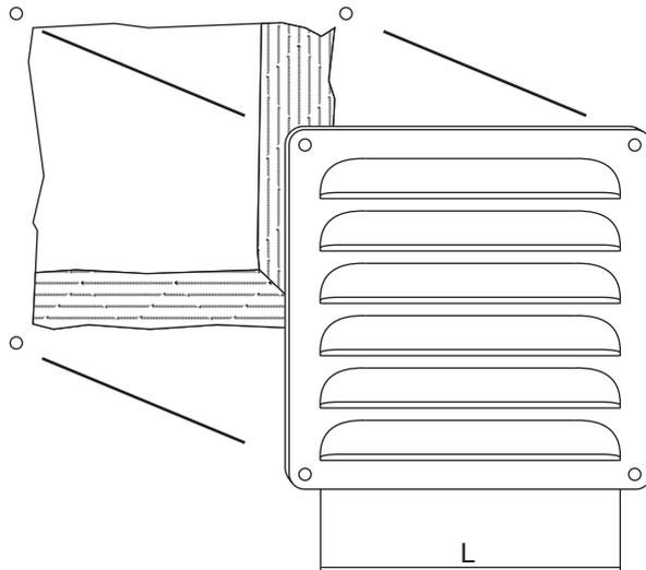
NOTA: la rejilla o rejillas de entrada de aire deben cumplir con la norma NAG215 establecida por ENARGAS y su superficie útil de ventilación debe coincidir o ser mayor a la dada anteriormente.
