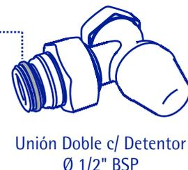
**Nota:** para reducciones con asiento de junta planos se utiliza junta de fibra, mientras que para reducciones con asiento cóncavo son de silicona.
